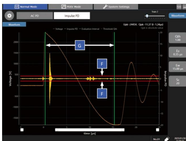
Podešavanje PD praga i prozora za prosuđivanje
